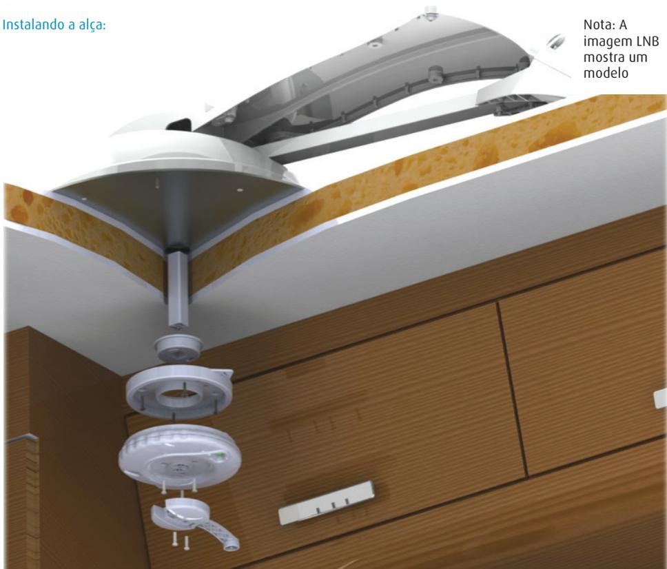
1. Empurre o tubo de alumínio no acoplador de plástico e insira-o na unidade da antena através do orifício no teto. Com o acoplador de plástico empurrado firmemente para o teto, marque o tubo de alumínio ao longo dos quatro lados.
